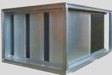
Prigušivači zvuka imaju zadaću svesti na minimum zvučna zračenja koja generiraju ventilatorska jedinica i buka strujanja na mreži kanala. Korištenjem različitih tipova prigušivača i širina kulisa možemo optimalno prilagoditi emisiju buke na sustav kanala potrebama kupca uz istodobno manje gubitke tlaka.
