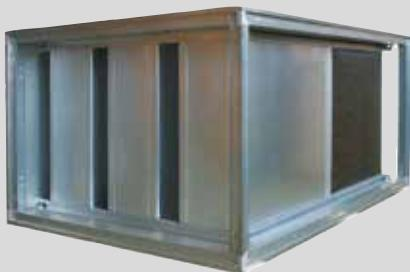
Kulise od mineralnih vlakana optimizirane za protok s pokrovom od folije od staklenih vlakana [ispitano prema DIN EN ISO 7235], razred materijala A1 [nezapaljivo prema DIN 4102], napolna premazano apsorpcijskim i reflektirajućim materijalom, zatvorene u pocićani čelični okvir, površine koje odbijaju vlagu, otporne na abraziju do 20 m/s, širina kulisa 200 mm.
