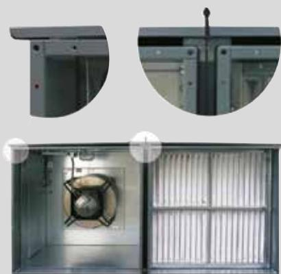
Debljina ploča oplate 50 mm, sastoji se od termički odvojene unutarnje i vanjske oplate od potpuno pocićanog čeličnog lima prema EN 10142 i EN 10143 (kod profila okvira 76 mm (KG 450, 510, 600, 680, 850, 1000), dno i gornja ploča u izvedbi debljine 76 mm). Zvučna i toplinska izolacija visokokvalitetnom, nezapaljivom toplinskom izolacijom od mineralne vune, razred materijala A1 prema DIN 4102, protuklizno i protuvibracijski učvršćenom između unutarnje i vanjske obloge.
