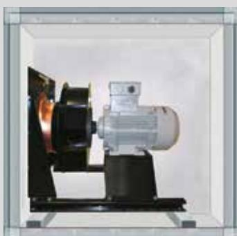
Ventilatorska/motorna jedinica sa slobodnim, unatrag nagnutim snažnim kolom u protueksploziskoj izvedbi prema ATEX 100 [električno provodljiv lak, rotor s ulaznom sapnicom od mesinga ili bakra, motor inkapsuliran s otpornošću na tlak u skladu sa smjernicama ATEX].
