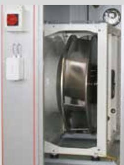
Posebno tih, visokoučinkovit, jednostrano usisni ventilator slobodnog hoda, izravno spojen s EC motorom 50 ili 60 Hz, energetski razred IE4. Bezstupanjska regulacija broja okretaja preko upravljačkog signala od 0 - 10 V
